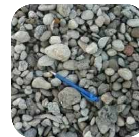
Couche de drainage : galets 16/32
